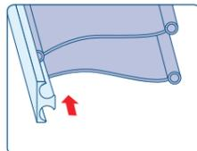
Unire in coppia le ante trasparenti tramite l'infilo dell'apposita cerniera
