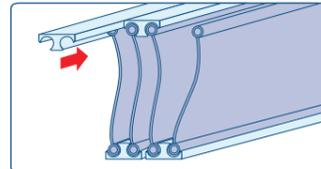
Posizionare su un piano orizzontale le coppie preassemblate ed unirle tra loro tramite l'infilo delle altre cerniere
