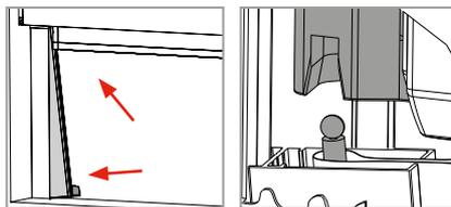
Se la zanzariera **non scorre correttamente**, ripetere l'operazione di inserimento delle guide (n°7).
