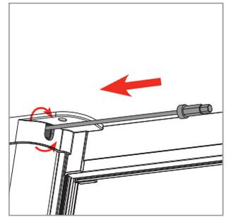
Inserire la chiavetta nel foro per regolare il caricamento della molla.
