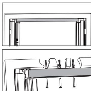
**7** Inserire il compensatore superiore e fissarlo utilizzando gli appositi fori.
