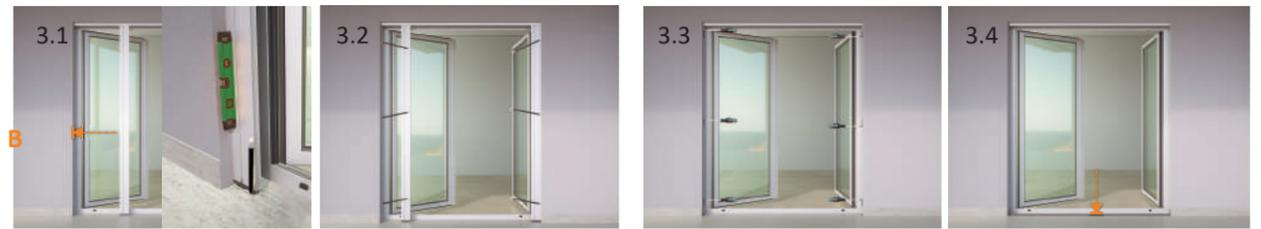
**3.1** Inserire la zanzariera nella guida superiore. Con l'uso di una livella, allineare e segnare sul pavimento
