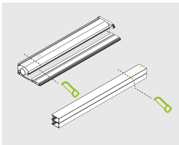
Misurare le dimensioni del vano. Rilevare larghezza e altezza in più posizioni e considerare la più piccola. Per effettuare il taglio di cassetto e guide sottrarre la misura del vano alla misura standard della zanzariera e tagliare l'eccesso.
