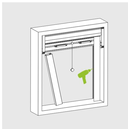
Inserire il cassetto nel vano, segnare i punti in cui forare attraverso i fori di entrambe le testate, togliere il cassetto, praticare i fori nel vano, reinserire e fissare il cassetto con viti e tasselli in dotazione usando un avvitatore.
