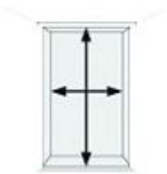
Misurare le dimensioni del vano
