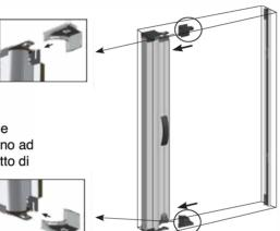
Inserire nel profilo di chiusura i fermaguida, avendo preventivamente controllato la polarità del magnete e quindi definito la posizione dell'alto e del basso. Posizionare il profilo di chiusura sullo stipite opposto al corpo zanzariera. Forare e fissare con le viti e i tasselli in dotazione
