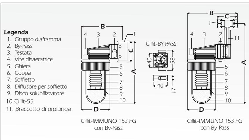
Fig. 1 - Esempi di installazione Cillit-IMMUNO 152-153 By-Pass FG sull'acqua di alimento a caldaie murali
