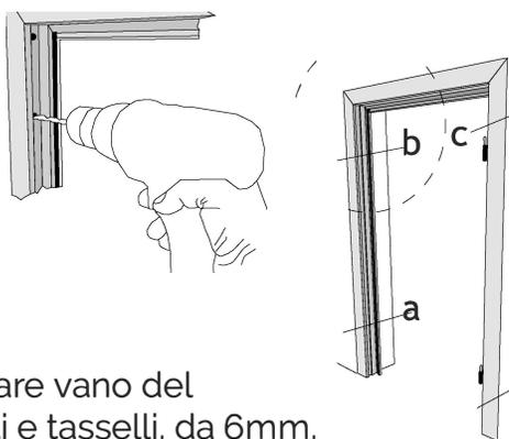
Forare e fissare vano del muro con viti e tasselli da 6mm, sui due lati verticali del telaio così come indicato con le lettere a, b, c, d in figura.
