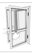
6 Chiudere l'anta fissa e abbassare il fermo inferiore, in modo da poter segnare con una matita la posizione dove andare a forare sul pavimento.
