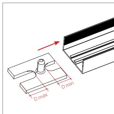
**1** Inserire la baionetta nel compensatore superiore nel verso mostrato in figura (D max lato esterno).
