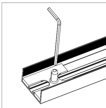
**2** Fissare la baionetta mediante la chiave a brugola in dotazione.
