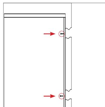
**5** Fissare il profilo di riscontro al muro.
