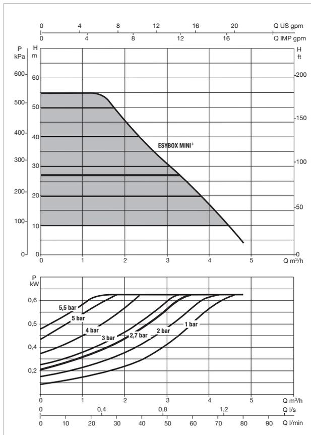
Le curve di prestazione sono basate su valori di viscosità cinematica = 1 mm<sup>2</sup>/s e densità pari a 1000 kg/m<sup>3</sup>. Tolleranza delle curve secondo ISO9906.
