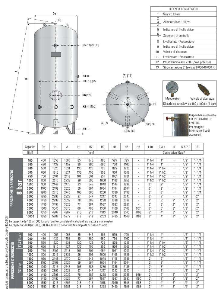
Le capacità da 100 a 1000 It sono fornite complete di valvola di sicurezza e manometro. Le capacita 5000 (ø 1600), 8000 e 10000 It sono fornite complete di passo d'uomo
