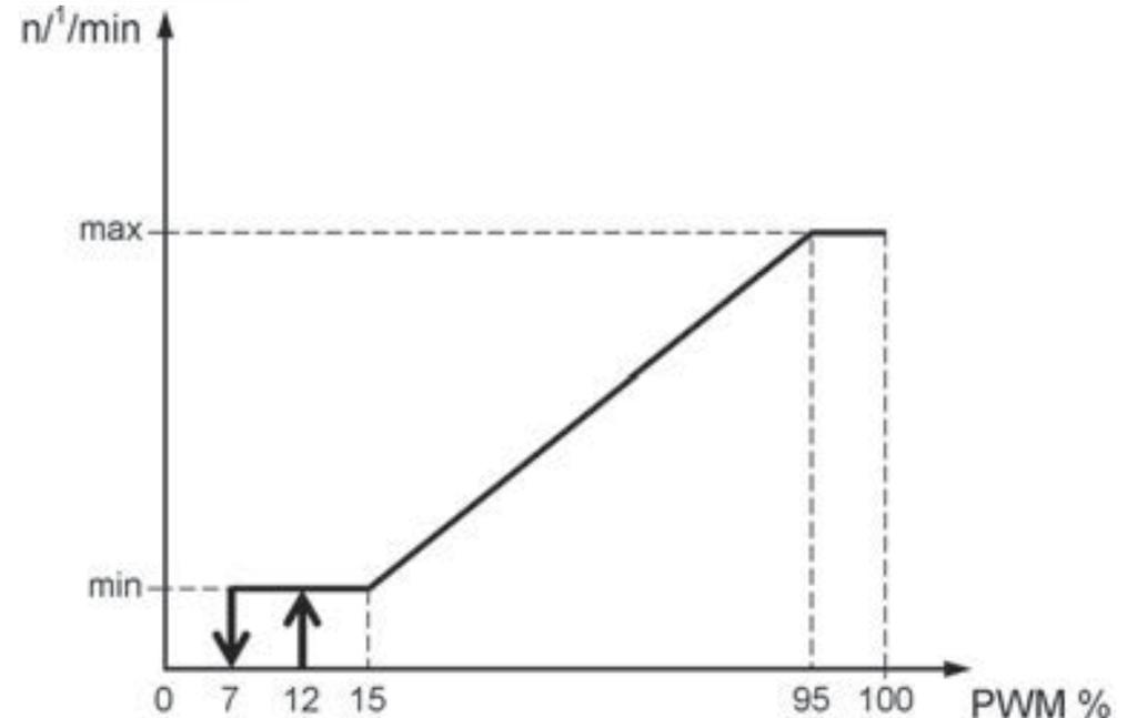
La pompa collegata sulla uscita PWM funziona secondo lo standard "PWM2", mediante la logica solare, anche detta normale.
