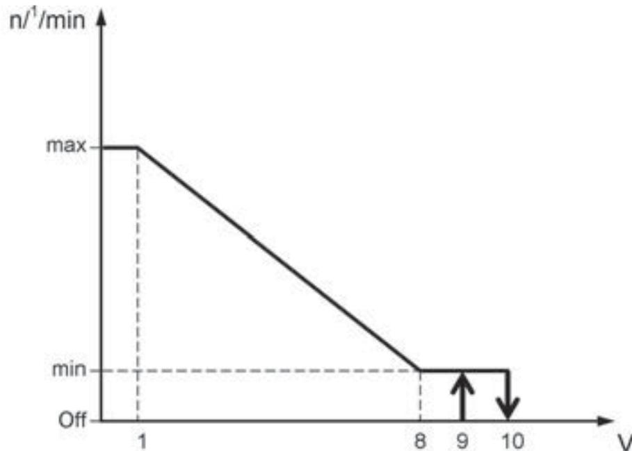
La pompa collegata sulla uscita 0..10V funziona secondo lo standard 0V .. 10V invertito (R010V). Con il segnale di uscita
