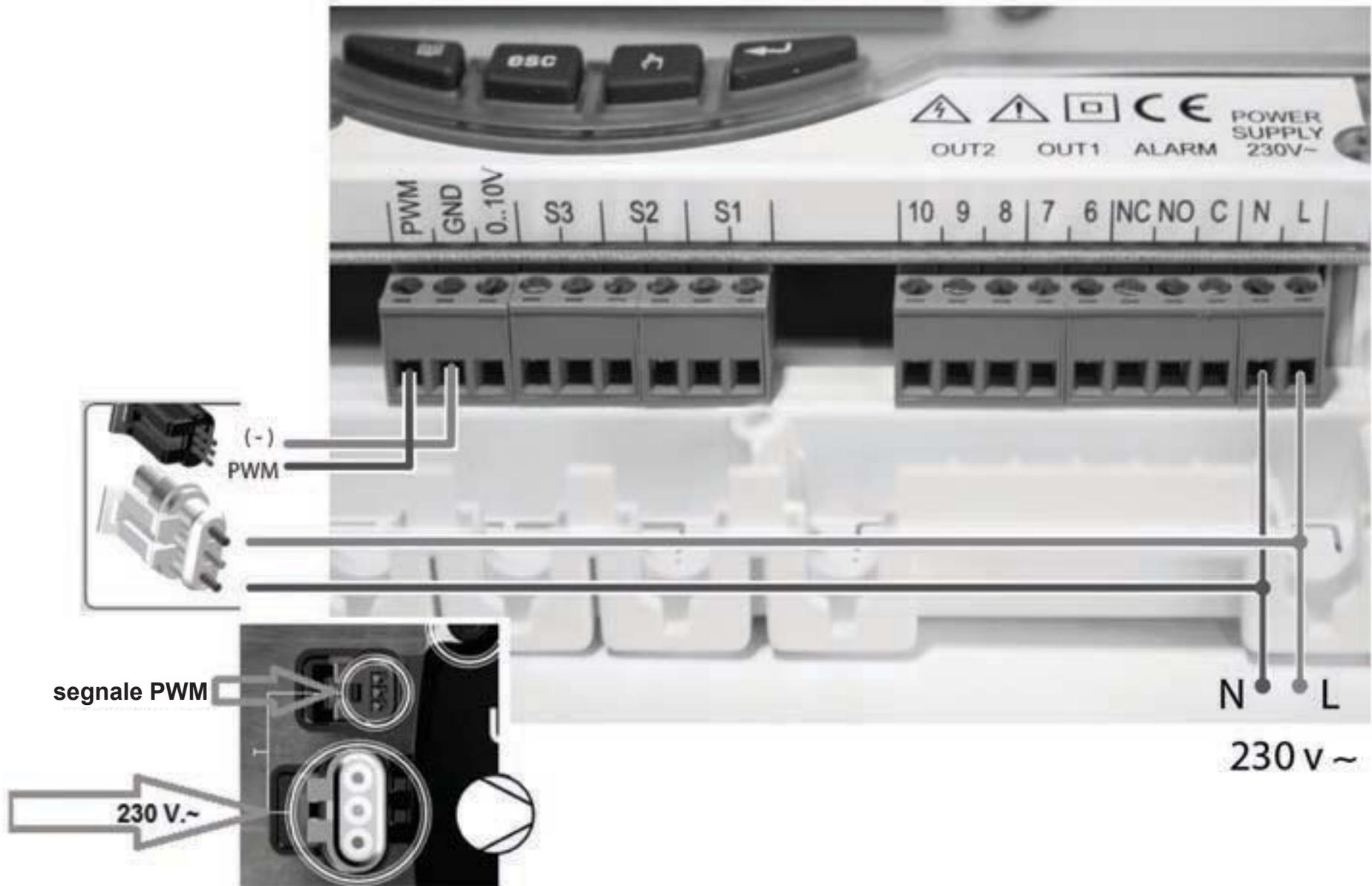
**ESEMPIO DI COLLEGAMENTO PER CIRCOLATORI SOLARI A 3 VELOCITA' CON ROTORE BAGNATO OPPURE "HIGH EFFICIENCY", CONFORMI ALLA DIRETTIVA ErP 2015, CHE NON NECESSITANO DI SEGNALE PWM ESTERNO (SENZA CONNETTORE PER PWM).**
