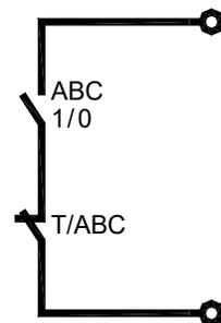
La logica di controllo relativa ai comandi della funzione 'ABC' si sostituisce al controllo del differenziale.
