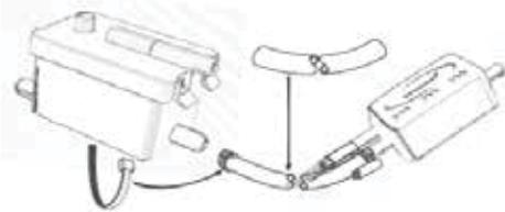
7. Collegare il tubo di all'uscita del raccordo sulla MDF e fissarlo con una fascetta.
