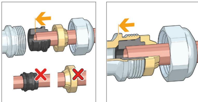
Introdurre la guarnizione nella sede della valvola, premendo a fondo, fino a battuta. Imboccare la calotta e serrare con una chiave esagonale da 26 mm, esercitando una coppia minima di 25 N·m.
