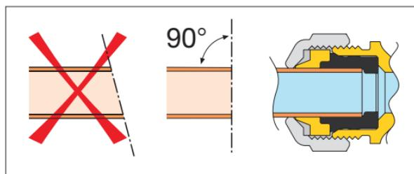
Inserire la calotta cromata nel tubo, l'anello stringitubo e la guarnizione di tenuta, rispettando il corretto senso di inserimento.
