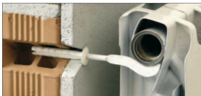
TF 10/65 BP mensola a sezione piatta (3 mm) smussata in punta con tassello ø 10 mm. Colore bianco RAL 9010. Per radiatori in alluminio con aletta interna.
