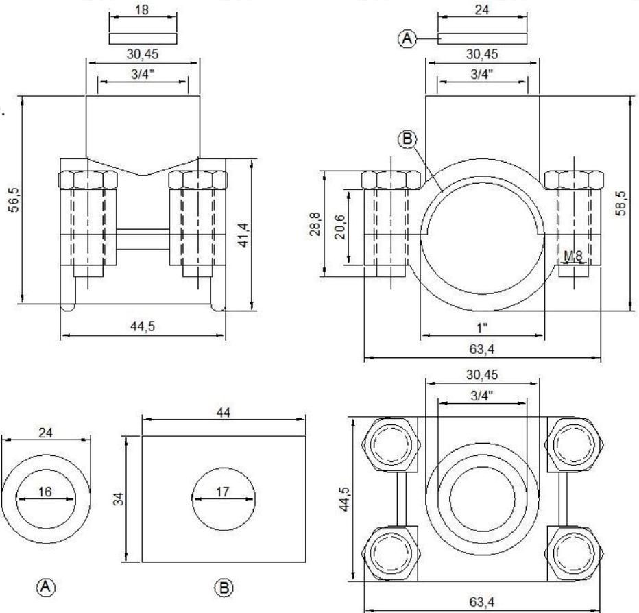
**Coppia massima di serraggio 1,1kgm = 11Nm. Durante l'installazione il prodotto deve essere serrato mediante l'utilizzo di chiave dinamometrica. Un eccessivo serraggio può danneggiare il pezzo.**
