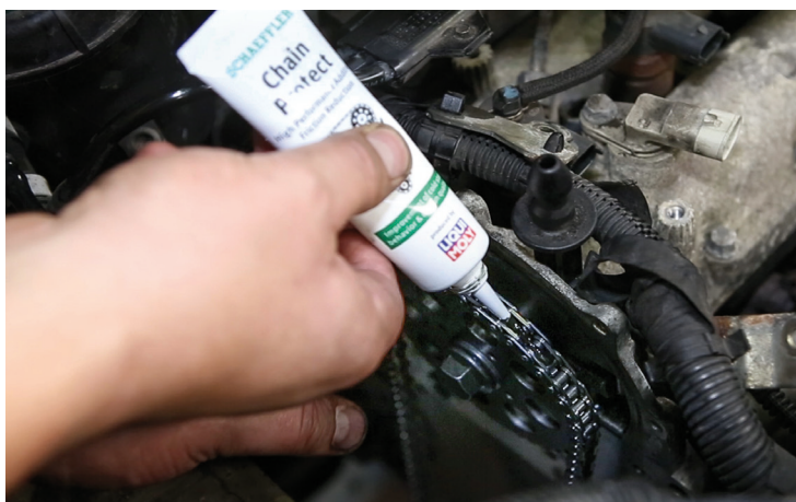
Afbeelding 2: Schaeffler Chain Protect wordt tijdens de montage van de ketting aangebracht op alle componenten in de distributieaandrijving.
