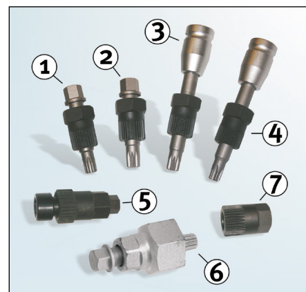
5. ábra: A szükséges célszerszámok a különböző szabadonfutó szíjtárcsa ki- és beszereléséhez
