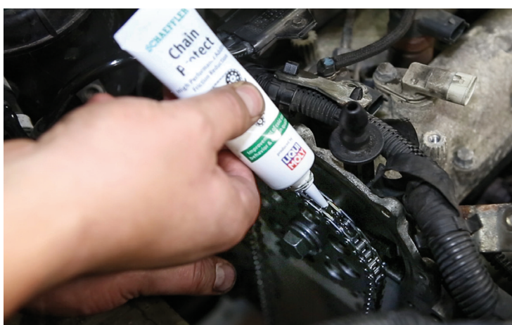
Photo 2 : Lors du montage de la chaîne, Le Schaeffler Chain Protect est appliqué sur tous les composants de la distribution.
